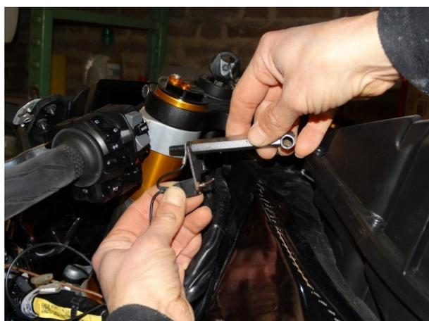
Avec la vis de la cocotte d'embrayage passez dans le support et la cosse à oeillet de mise à la masse
